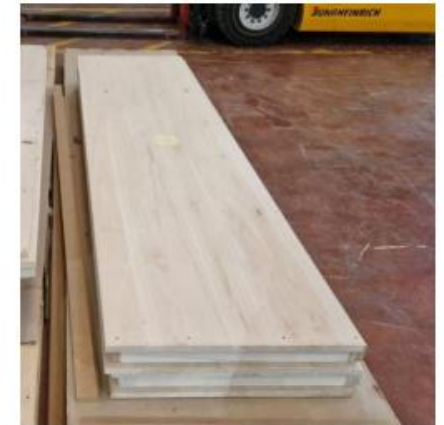
Figura 4-10. Módulos de partición interior cerrados.
